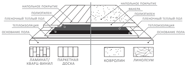
Рисунок 23. Схемы укладки твердых и мягких напольных покрытий.
